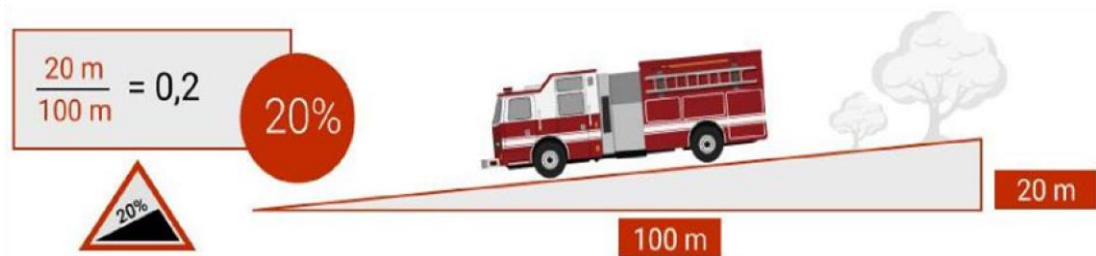
Figure 1 : Schématisation d'essai du frein de stationnement
